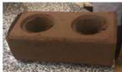
Figura 3: Tijolo solo cimento com rejeito da mineração, Fonte: Própria
